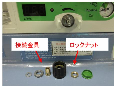
写真 流量調整ダイヤル構成部品
