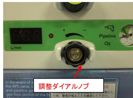
ニードルと調整ダイヤルノブはロックナットおよび接続金具によって固定されており、弊社エンジニアによる定期点検実施時には調整ダイヤルの動作確認を行っております。今回の事例につきましては、このロックナットに緩みが生じたために調整ダイヤルを回転させてもニードルが回転しない状況が発生したものと考えられます。
